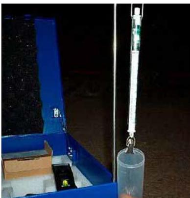
Per la pesatura dei campioni di muratura, si è utilizzata una bilancia a dinamometro, del tipo raffigurato a fianco, di precisione pari a 0,1 g.
